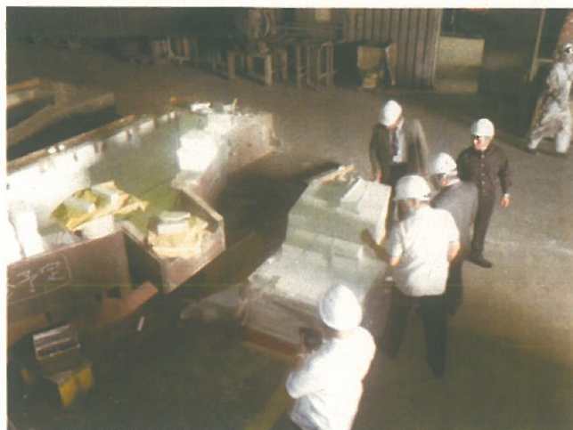
熔解した鉄を受ける部分の補修（耐熱レンガ）
